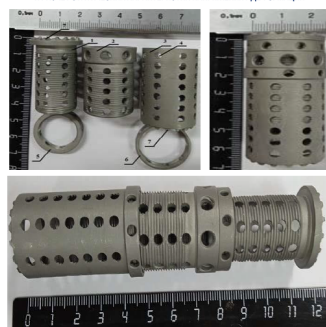
ЭКСПЕРИМЕНТАЛЬНЫЙ ОБРАЗЕЦ ИМПЛАНТАТА В СОБРАННОМ И РАЗОБРАННОМ ВИДЕ И РАСЧЕТ СТАТИЧЕСКИХ ХАРАКТЕРИСТИК НАПРЯЖЕНИЯ / ДЕФОРМАЦИИ
